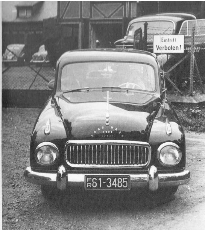
Auf dem Fahrgestell des Hansa 1500 Sport baute das Karosierewerk Deutsch 1953 dieses „Coupé“. Es war eine Sonderanfertigung für Freiherrn von Sazenhofen-Wiedersperg. Unter der Haube steckte der 80 PS-Carrera-Motor, mit dem das Fahrzeug eine Höchstgeschwindigkeit von fast 170 km/h erreichte.
